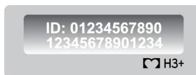
Um die Aufzeichnung zu einem frühen Zeitpunkt zu beenden, kann die Batterie aus dem Recorder entnommen werden. Damit wird die Aufzeichnung gestoppt. Bei einem erneuten Einsetzen der Batterie wird die ID in umgekehrter Farbe angezeigt, wie oben dargestellt.
