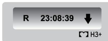
Um ein Ereignis nach der ersten Minute der Aufzeichnung einzugeben, drücken Sie die **Ereignis**-Taste am H3+. Ein • wird rechts neben der aktuellen Uhrzeit angezeigt, bis eine neue Eingabe möglich ist.
