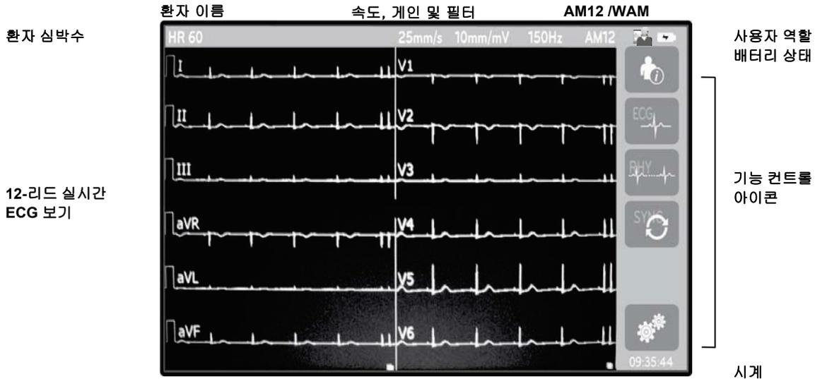
**참고:** WAM을 사용하는 동안 두꺼운 기저선이 표시되는 이유는 WAM이 꺼져 있거나 배터리가 없거나 간섭이 있거나 WAM이 범위를 벗어났거나 보정 오류가 발생했기 때문일 수 있습니다. WAM의 LED 표시등을 검토하여 장치가 켜져 있고 배터리 잔량이 적당한지 확인합니다. WAM이 올바르게 페어링되어 있고 심전도계와 권장 근접 거리에 있는지 확인하고 WAM을 껐다 켜서 다시 보정하십시오. 자세한 내용은 WAM 사용 설명서를 참조하십시오.
