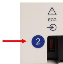
Um rótulo circular com o número 2 na parte de trás do eletrocardiógrafo ELI, localizado ao lado do conector de entrada de ECG, indica que o eletrocardiógrafo contém, internamente, um **UTK** versão 2.
