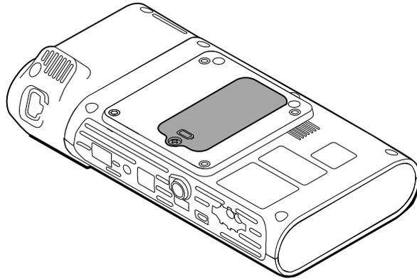
2. Localisez le capot de la batterie, signalé par la présence de
