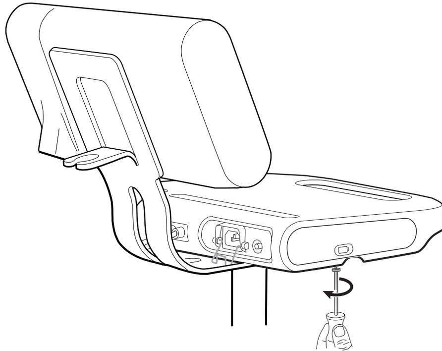
2. Retirez le capot du compartiment de la batterie et mettez-le de côté.
