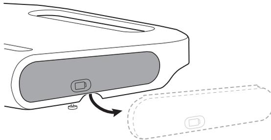
3. Soulevez doucement le verrou d'une main et, de l'autre main, tirez la patte du dessus de la batterie afin de sortir la batterie de son logement.
