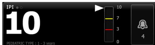
La visualizzazione numerica include anche un indicatore grafico del valore IPI corrente del paziente. Come mostrato negli esempi seguenti, quando il valore IPI è 8, 9 o 10 il contorno della barra verticale è grigio. Quando il valore IPI è 4, 5, 6 o 7 il contorno della barra è giallo e la sua sezione centrale diventa gialla. Quando il valore IPI è 1, 2, o 3 il contorno della barra è rosso e la sua sezione inferiore diventa rossa.
