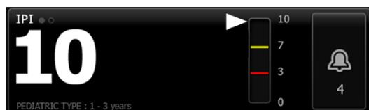
数字视图还包括患者当前 IPI 值的图形指示器。如以下示例所示，IPI 值为 8、9 或 10 时，垂直指示条的轮廓为灰色。IPI 值为 4、5、6 或 7 时，指示条的轮廓为黄色，指示条的中间段为黄色阴影。IPI 值为 1、2 或 3 时，指示条的轮廓为红色，指示条的最低段为红色阴影。
