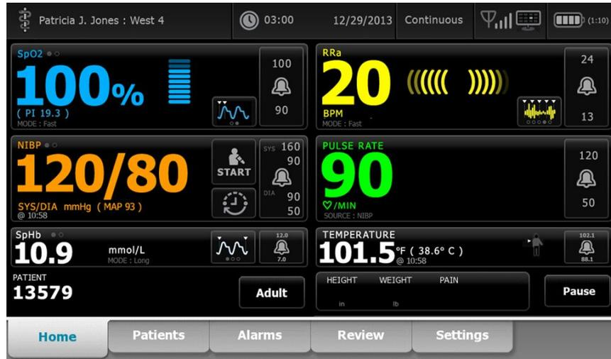
간헐적 저장 기능이 활성화된 상태에서 연속 프로파일의 수동 간헐적 저장 워크플로는 Home(홈) 탭의 저장 버튼을 사용하여 시작됩니다. 모니터 전원을 켜거나 다른 프로파일에서 연속 프로파일로 전환하는 즉시 Save(저장) 버튼은 사용할 수 없게 됩니다. 그러나 Connex CS 시스템에 연결할 때 모니터는 호스트 서버에 설치된 Connex CS의 버전을 확인하고, 지원되는 경우 연결된 모니터에서 지원되는 Connex CS 버전이 설치된 것을 확인하면 Save(저장) 버튼이 나타납니다.
