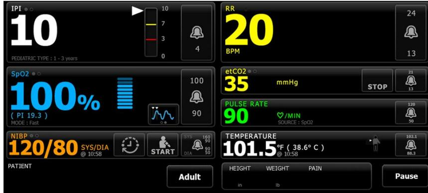
간헐적 저장 기능이 활성화된 상태에서 연속 프로파일의 수동 간헐적 저장 워크플로는 Home(홈) 탭의 저장 버튼을 사용하여 시작됩니다. 연속 모니터링 프로파일에서 일시 중지 버튼이 그 자리에 나타나지만, 간헐적 저장 기능이 활성화된 경우 모니터에서 호스트 서버에 설치된 Connex CS의 지원되는 버전을 확인하면 두 버튼이 모두 나타납니다. 이 사용 지침서의 "수동 간헐적 바이탈 사인 측정(연속 모니터링 프로파일)" 및 "호스트 시스템"을 참조하십시오. 모니터가 중앙 스테이션에 연결된 경우, 모니터는 이러한 환자 측정값을 자동으로 중앙 스테이션에도 보냅니다.
