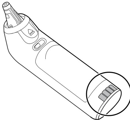
3. Laissez le thermomètre de côté pendant 1 minute afin que les contacts sèchent à l'air.
