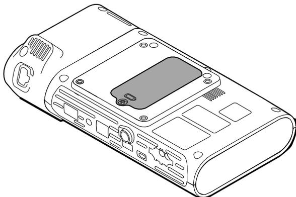
2. Localisez le capot de la batterie, signalé par la présence de
