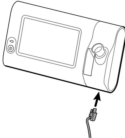
3. Insérez la sonde SureTemp dans le puits de sonde.
