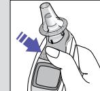
El termómetro Braun ThermoScan se desconecta automáticamente tras 60 segundos, si no está en funcionamiento. También puede desconectarse si el botón « $\wedge$ » se pulsa durante 3 segundos como mínimo. En la pantalla aparece brevemente y parpadeando la indicación «OFF» que luego queda permanentemente en la pantalla una vez que se suelta el botón.
