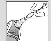
Nota: No utilizar ningún producto químico que no sea alcohol isopropílico para limpiar la ventana de la sonda.
