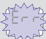
La température ambiante n'est pas comprise dans l'intervalle de températures de fonctionnement autorisé (50-104 °F ou 10-40 °C) ou ne reste pas constante.
