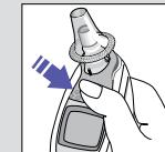
Le thermomètre ThermoScan Braun s'éteint automatiquement au bout de 60 secondes s'il n'est pas utilisé. On peut également l'éteindre directement en appuyant sur la touche « $\wedge$ » pendant au moins 3 secondes. A l'écran, le mot «OFF» clignote rapidement puis reste affiché en continu une fois la touche relâchée.
